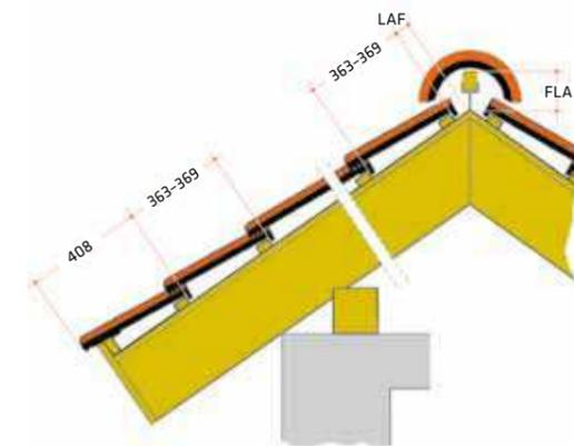
Карниз с глубоко посаженным водосточным желобом, конек с уплатнительной лентой.
