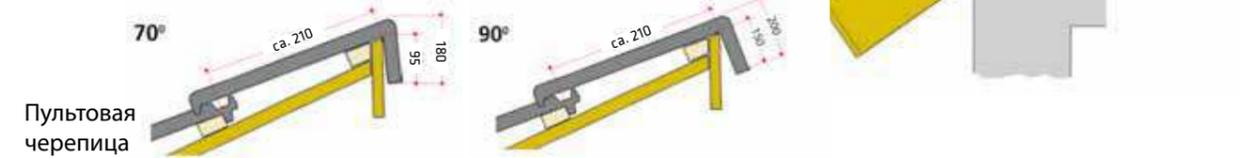
Карниз с глубоко посаженным водосточным желобом, конек с уплатнительной лентой.
