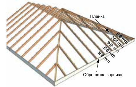
Стропила. Установите интервал между гвоздями
