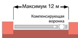
Если конфигурация соответствует рис. В и есть препятствия линейному расширению желоба, то используется компенсирующая воронка при условии, что длина карниза не превышает.
