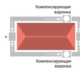
Если водосточные желоба образуют замкнутую систему из 4 сторон, как показано на рис. D, то необходимо применять компенсирующие воронки и компенсаторы в комплексе.\*
